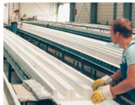
Bild 11: Ausrichten der KS-Sturzschalen.
