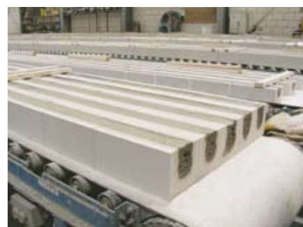
Bild 13: KS-Flachstürze nach dem Verfüllen.
